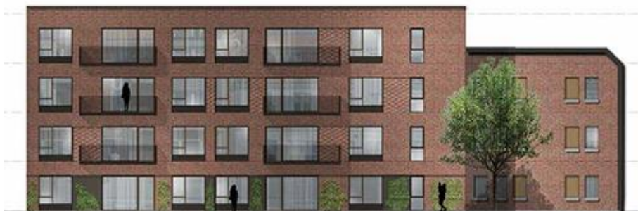
Figur 4: Facadetegning af ny bebyggelse mod vest, der viser detaljer i murværket med mønstre på felter mellem vinduerne. Stueetagen er ledsaget af beplantning ved de murede felter og træer.
