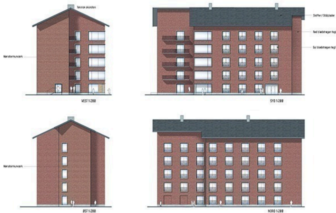
Figur 3: Illustrerede facade tegninger viser, hvorledes bygningen har indhak og en rytmisk facade udformning, der viser, at indretningen er ens på alle etager.
