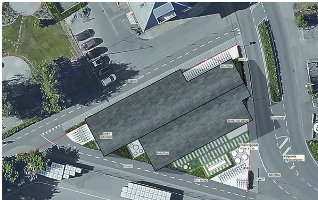
Figur 2: Situationsplan viser bygningens placering i lokalplanområdet og de ubebyggede arealers indretning. De ubebyggede arealer indrettes som ankomstarealer med beplantning, affaldshåndtering og cykelparkering. Tagfladerne er vist med tagudhæng.
