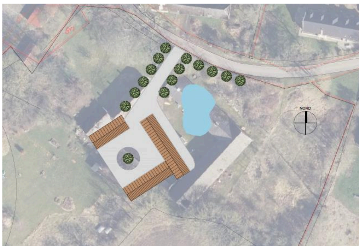
Figur 2: Oprindelig skitse af tankerne bag projektet. Den 3 længede struktur trækkes let væk fra vejen, og gør plads til regnvandsopsamling og allé.
