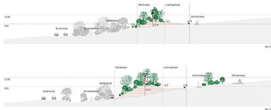
Figur 3 Uddrag fra bilaget 'Støjskærm Udformning, Kølholt, Skibet, Vejle', hvor snittene er rettet således støjskærmningen i mindre grad ligger i servitutbæltet.
